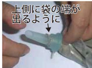
ノズルに、キャップを被せます。このとき、キャップから袋の端が全部出るように調整します。
